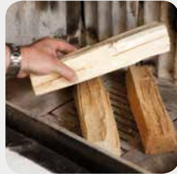
Das Holz locker in den Brennraum schichten.
