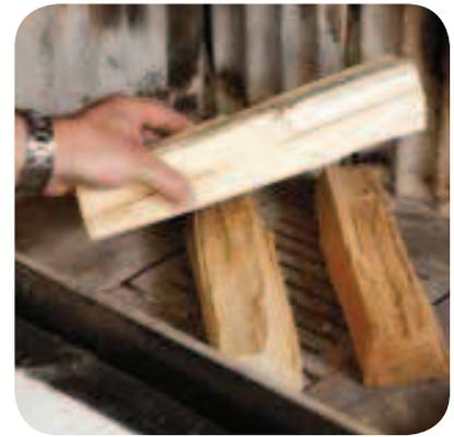
Das Holz locker in den Brennraum schichten.
